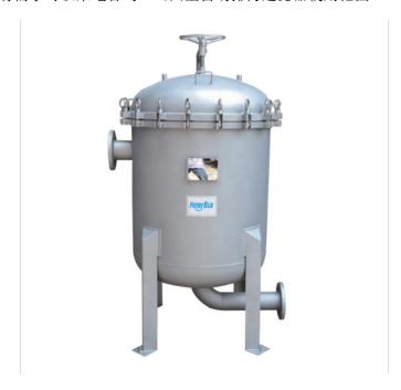
活性炭过滤器设备介绍:活性炭过滤器,外壳一般为不锈钢或者玻璃钢,内部填充活性炭,用来过滤水中的游离物,微生物,部分重金属离子,并能有效将低水的色度,活性炭过滤器是一种较常用的水处理设备,作为水处理脱盐系统前处理能够吸附前级过滤中无法去除的余氯,可有效保证后级设备使用寿命,提高出水水质,防止污染,特别是防止后级反渗透膜,离子交换树脂等的游离态余氯中毒污染,同时还吸附从前级泄漏过来的小分子有机物等污染性物质,对水中异味、胶体及色素,重金属离子等有较明显的吸附作用,还具用降低COD的作用。以上是上海喜蓝给大家带来的活性炭过滤器的介绍。山西全自动排污过滤器使用范围喜蓝(上海)环境科技有限公司是一家专业提供过滤器的公司,欢迎新老客户来电!
